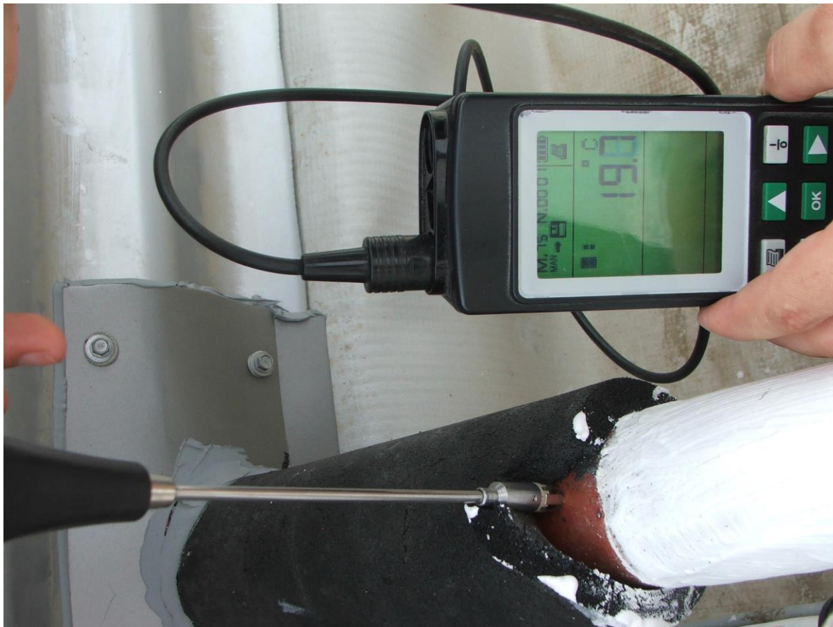
5. kép: csak alapozott csőszakaszon a felületi hőmérséklet 20 °C
